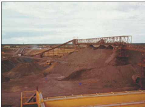
Австралийский урановый рудник Олимпик-Дэм: отвалы урановой руды (слева) и установка для ее измельчения (справа)
