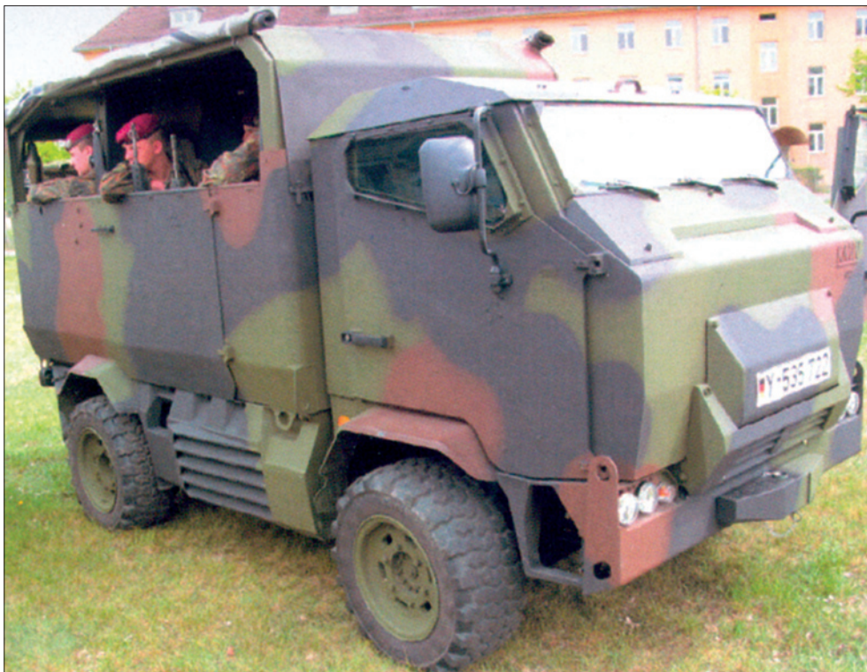
Броневеомобиль «Мунго» предназначен для перевозки экипированных десантников или военнослужащих спецназа
