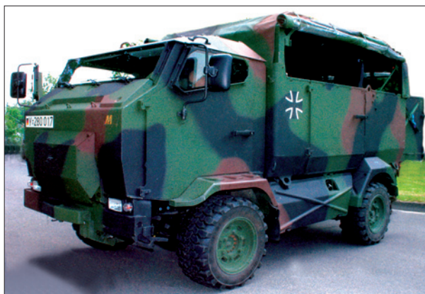
Корпус автомобиля выполнен из сварных броневых листов и обеспечивает защиту экипажа и десанта от пуль калибра 7,62 мм, осколков гранат и некоторых типов противопехотных мин
