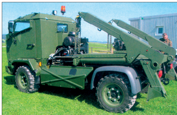
Транспортный вариант бронеавтомобиля «Мунго» для перевозки легких контейнеров
